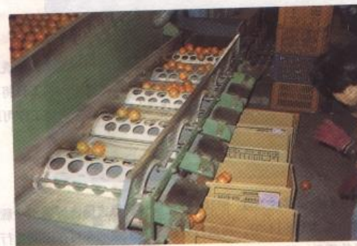
圖 14-4 柳橙在進行機械分級處理
