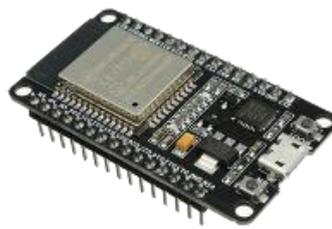
圖七: ESP32 Wi-Fi&Bluetooth 單晶片微控制器(資料來源: <https://reurl.cc/bzDKoy>)
