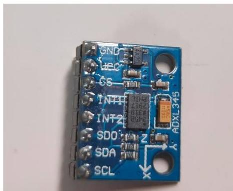
圖 一: ADXL345 三軸加速度計
