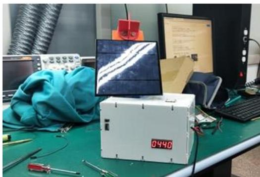
圖(三)七段顯示器顯示亮度
