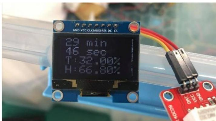
倒數 30 分鐘停止製冷片&風扇運作
