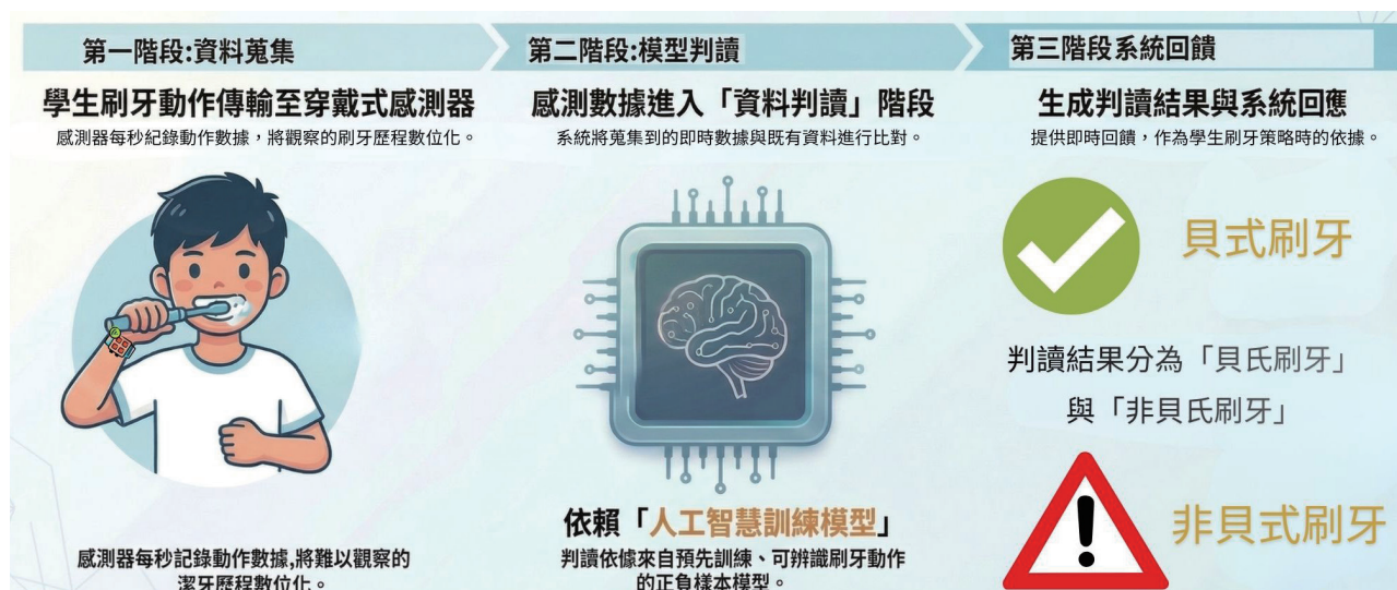
圖 1：智慧牙刷 AIoT 系統運作架構圖
